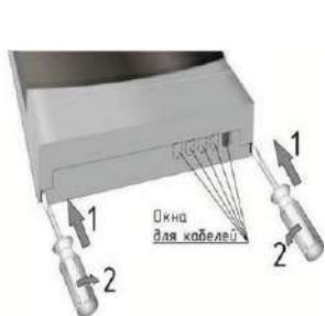
Рисунок 2 – Снятие крышки клеммного отсека
